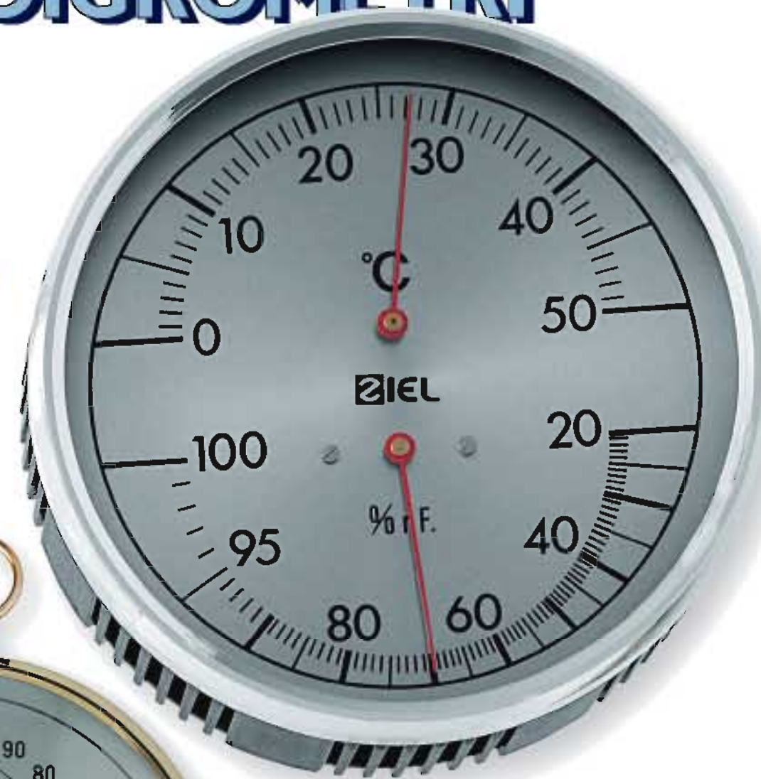
Cod. 71.02.05 Termoigrometro di precisione ♦ Igrometro a elemento sensibile "POLYTERM" ♦ Utilizzabile fino a 90 °C ♦ In metallo cromato ♦ Dimensioni: Ø 130 mm
